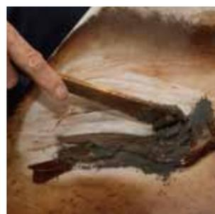
Le *jinoko* de *Wajima* est classé en fonction de la taille de ses particules et est appliqué sur le substrat mélangé à de l'*urushi*. La première couche, l'*ippenji* est la plus rugueuse, les couches ultérieures évoluant vers une moindre granulosité. A chaque étape, la surface séchée est poncée jusqu'à donner à chaque couche une finition pure et tisse.
