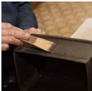
底漆作业也称作“敷底”，这是一个在熟知素材性质基础上的作业顺序，需要根据器物整体造型来考虑涂层厚度及相应的打磨方法。这是一个容不得丝毫疏忽的重要工序，否则难以成就器物的高雅格调。
