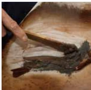
按地粉粒子从粗到细的顺序进行涂层，即一边地粉、二边地粉、三边地粉的覆盖涂抹。每一道涂抹都需要时间来使其干燥，反复打磨，并在边缘等部位涂上生漆，此道作业被称为“地缘涂抹”。这样，加工物体表面肌理渐渐地变得细腻。
